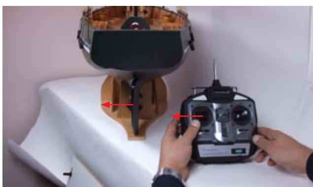
4. Передвиньте левую рукоятку передатчика влево. Руль направления должен отклоняться влево. Модель будет поворачивать влево.
