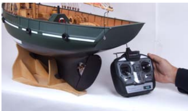
2. При нейтральном положении правой ручки передатчика, винт вращаться не должен. Если при центральном положении правой ручки передатчика гребной винт продолжает вращаться, устраните вращение, перемещая соответствующий триммер передатчика.
