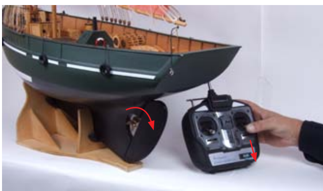
3. При перемещении правой ручки передатчика на себя, гребной винт должен вращаться в противоположном направлении, модель будет двигаться задним ходом. Если направление вращения гребного винта не соответствует выше описанному перемещению ручки передатчика, под крышкой батарейного отсека переключите реверс соответствующего канала.
