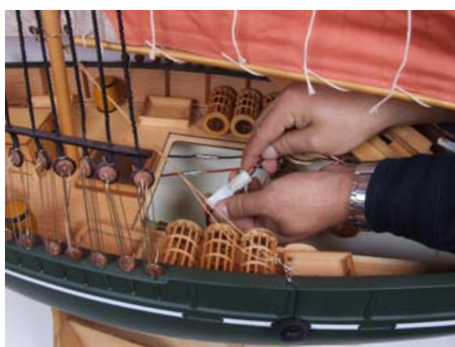
8. Еще раз убедившись, что выключатель питания модели находится в положении «Выключено», соедините разъем аккумулятора с разъемом регулятора оборотов.
