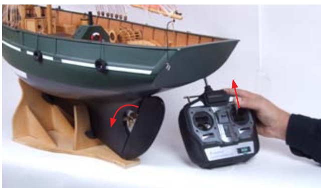
1. Плавно передвиньте правую рукоятку управления передатчика от себя. Гребной винт начнет вращаться, модель будет двигаться вперед.
