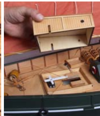
10. Убедитесь, что вращению винтов и руля направления ничего не мешает, включите питание модели. Проверьте работу электроники. Оденьте рубку.
